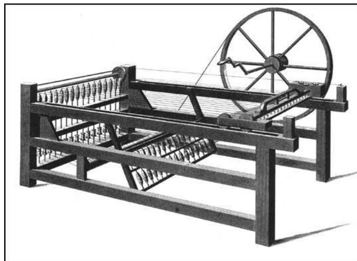
Abbildung 9: „Spinning Jenny“ (erste industrielle Spinnmaschine)
