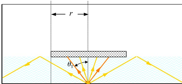
Abbildung 1: Es hat noch zu wenig Flüssigkeit im Tank. Bei dieser Füllhöhe blockiert die Scheibe alle Strahlen die nicht totalreflektiert werden.
