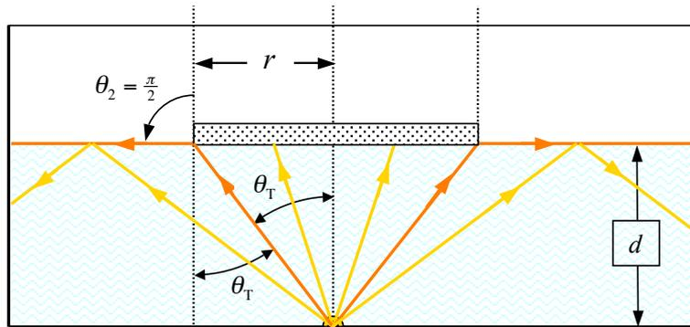
Abbildung 2: Der Grenzfall. Strahlen mit Einfallswinkel  $\theta_T$  treffen die Kante der Scheibe und werden dort entlang der Oberfläche gebrochen. Ein Beobachter über dem Tank sieht Licht, das von der Flüssigkeit um der Scheibe gestreut wird.
