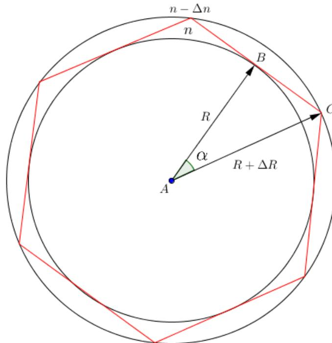
1) Das Licht breitet sich nur in kleiner Schicht von  $R$  bis  $R + \Delta R$  wie in der Abbildung aus und immer reflektiert von der äußeren Schichtoberfläche.
